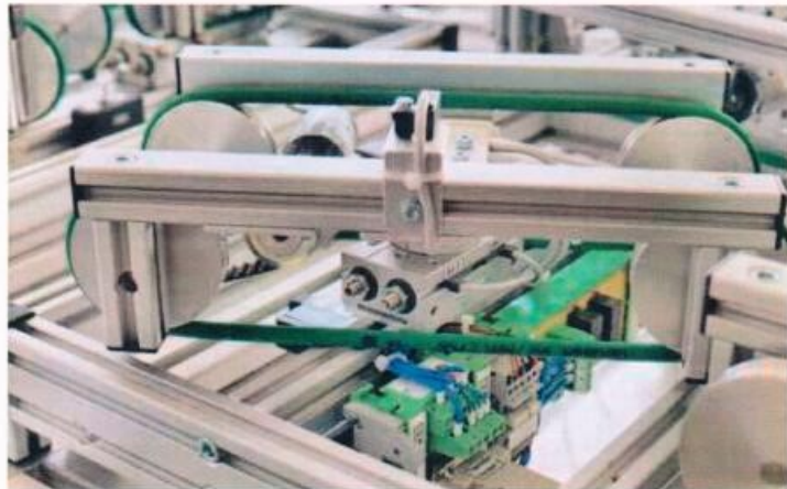
Drehzylinder zur Drehung der Paletten zeigen, dass die Pneumatik in der Lernfabrik keine Randtechnik darstellt, sondern sich auf Augenhöhe mit den elektrisch betriebenen Aktoren befindet.
